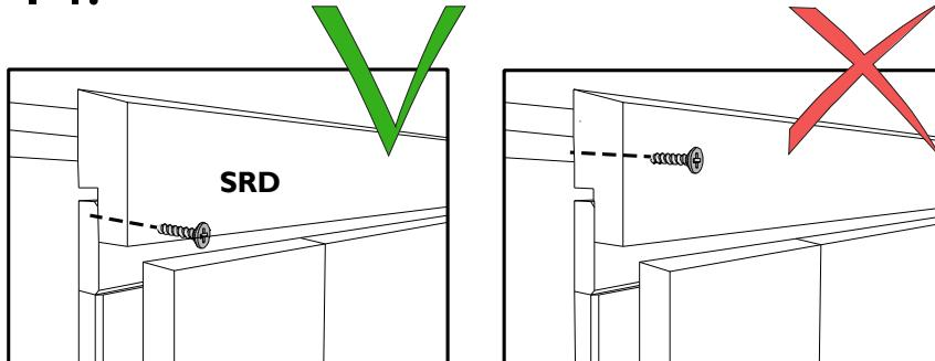
**NL:** Plaats de afdekklassen boven de ramen. Vijs aan de buitenkant de sierlat SRD bovenop de kader van het raam. Zij dient om de opening bovenaan te verbergen tijdens het werken van het hout (cfr "hout leeft"). Zet vast met vijzen van 25 mm **op de kader**.
