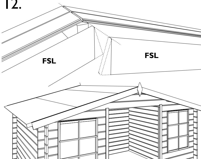
**NL:** Het dak dient nog afgewerkt met sierlatten voor- en achteraan. Zaag de meegeleverde frontierlatten (FSL) in verstek voor een mooie aansluiting bij de nok. Varnagel op de dakbalken (roofing zit tussen de balken en FSL). Varnagel eveneens aan de plank A5. Breng als afwerking het schildje aan waar de sierlatten samen komen. Kit de spleet tussen de roofing of shingles en de latten FSL af met siliconen (niet meegeleverd).
