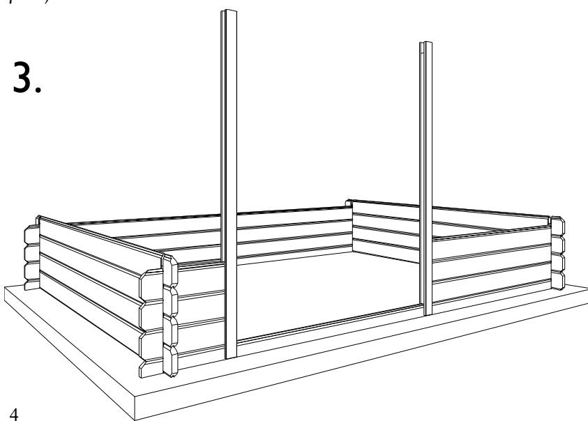
**NL:** Laat de deurstijlen in de opening zakken. **Mak de deurstijlen enkel onderaan aan de blokhut vast met een schroef, bovenaan vijst U nooit aan de blokhut zelf** (zie tips en adviezen 'hout leeft'). Het afwerken van de deur doet U best als de blokhut volledig gemonteerd staat.
