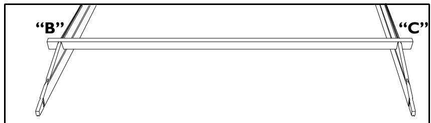
**NL:** Plaats de dakbalken in de uitsparingen van de puntgevels. Ga na in de onderdelen lijst hoeveel de dakbalken voor- en achteraan uit de puntgevel uitsteken (maat "B" en "C"). Nagel elke balk aan de puntgevel vast.
