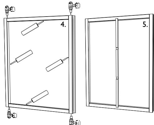
**NL:** Bouw verder op volgens de meegeleverde planjes (zie gedetailleerde onderdelenlijst) tot U ter hoogte van de onderkant van het raam komt. Plaats nu nog 2 lagen extra. Indien het model een raam in de zijwand heeft kan U zelf kiezen of U het raam in de linker- of rechterwand plaatst. Laat het raamkozijn in de opening zakken. **Maak uw kader niet vast dmrv schroeven of nagels aan uw bering!** (“Hout leeft”).
