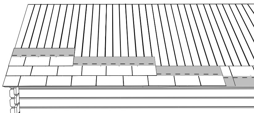
**NL:** Voor het afdekken van de nok dient U de shingles schuin in stukken te snijden zoals op de tekening op de pakken. Vervolgens legt U deze stukken overlappend op elkaar. Hou rekening met de richting van de stormwind bij de bepaling in welke richting U zal overlappen. Vernagel met 2 nagels op de plaats die door het volgende stuk wordt overlapt.
