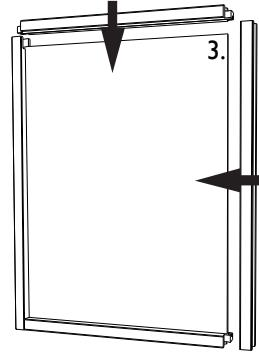
**NL:** Het raam dient nog in elkaar gezet te worden. Bestudeer aandachtig de tekeningen. De 4 kaderelementen worden in de groef aan elkaar gevezen met vijzen van 35 mm (stap 4). Gebruik voor het verticale latje vijzen van 20 mm (stap 5) en voor de horizontale latjes vijzen van 35 mm (stap 6). **Opgelat vergeet niet voor te boren om splijting van het hout te voorkomen.** Kit de ramen aan binnen en buitenkant af met silicone (niet meegeleverd).
