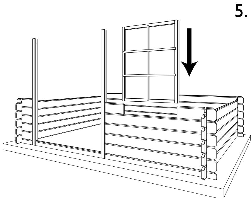
**NL:** Bouw verder, zoals aangegeven staat op de tekeningen van de wanden in de onderdelenlijst, tot U enkel nog de puntgevel moet plaatsen. De bovenste plank heeft geen tand, enkel een groef, zij is m.a.w. vlak bovenaan. Boven het raam bemerkt U een opening. Dit is normaal en noodzakelijk. Uw blokhut zal in de hoogte variëren naargelang de luchtvochtigheid. Deze opening dient om dit fenomeen op te vangen. Straks zal U deze opening afdichten met de bijgeleverde SRD lat.
