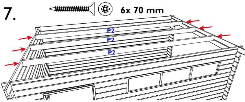
**NL:** Vijs de hulpdakbalken P1 telkens met 2 vijzen van 70mm door de voorwand vast in de kop van de hulpdakbalk. Hou de bovenkant van de hulpdakbalken gelijk met de bovenkant van de voorwand. Monteer het middelste hulpdakbalken perfect in het midden van de voorwand. De resterende hulpbalkjes verdeelt u symmetrisch (gelijke afstand tussen alle hulpdakbalken).
