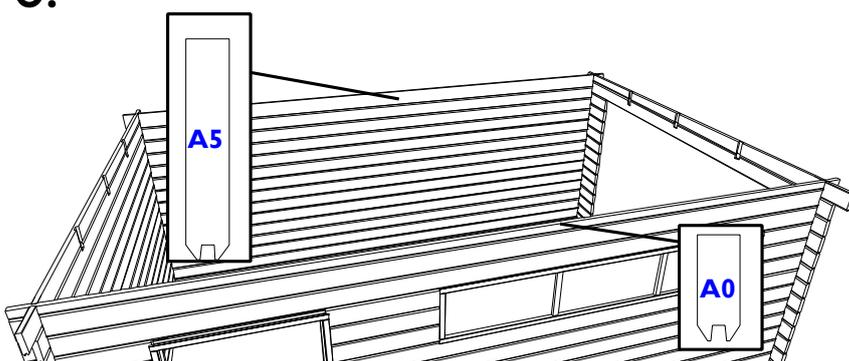
**NL:** Plaats achteraan de bovenste plank A5. Deze plank heeft geen tand, enkel een groef, zij is m.a.w. vlak bovenaan.
