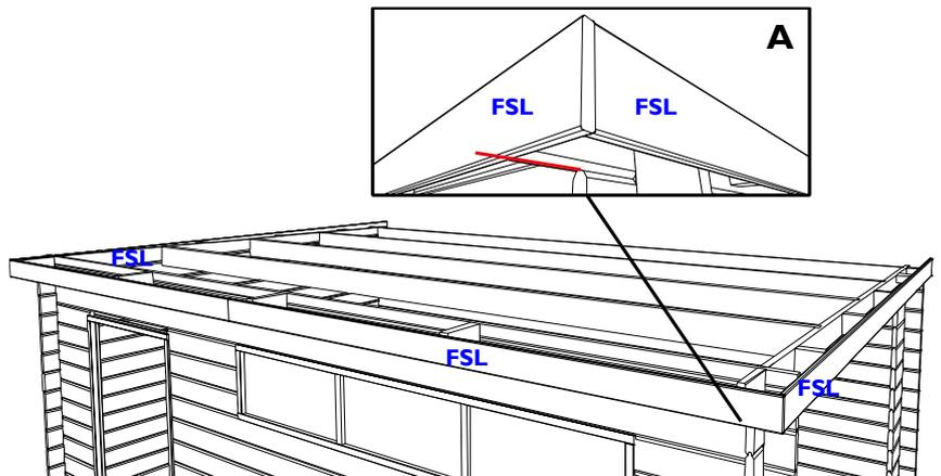
**NL:** Plaats nu de 2de laag frontale sierlatten FSL tegen de eerste laag, laat 5 cm overlappen. Begin opnieuw vooraan. Werk op de zelfde manier als de 1ste laag. Gebruik 5 vijzen van 25 mm per lat om de 2de laag aan de eerste van te maken.
