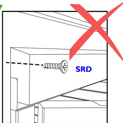
**NL:** Plaats binnen én buiten de sierlat SRD bovenop de kader van de deur. Zij dient om de opening bovenaan te verbergen tijdens het werken van het hout (cfr "hout leeft"). Zet vast met vijzen van 25 mm **op de deurkader**.
