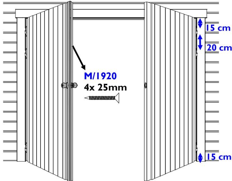
**NL:** Plaats links en rechts van de horizontale kader blokjes om deze bovenaan te blokkeren. Breng de grendels aan op de poort zonder klink. Plaats tenslotte aan de binnenkant de slaglatjes 599941 aan de kader tegen de poort met nageltjes.
