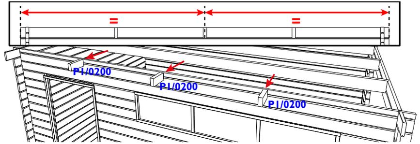
**NL:** Vijs de hulpdakbalkjes P1/0100 telkens met 1 vijs van 70 mm door de zijwand vast in de kop van het blokje. De voorste balkjes verticaal het achterste balkje horizontaal. Hou de bovenkant van blokje gelijk met de schuine zijde van de dakhelling. Verdeel de blokjes symmetrisch over de zijwand.
