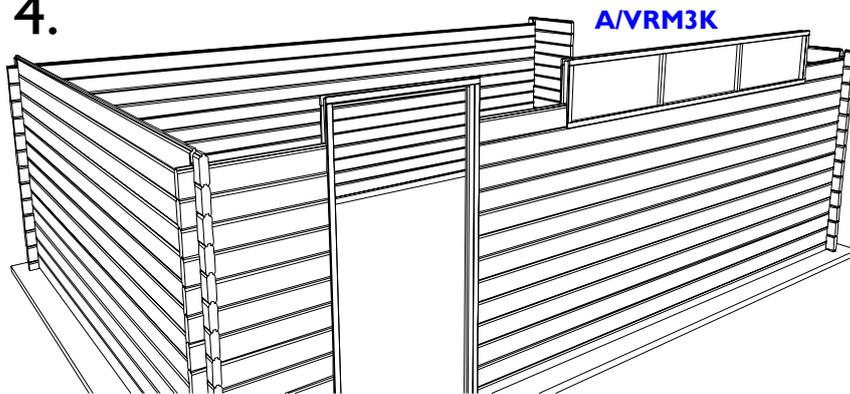
**NL:** Bouw verder op volgens de meegeleverde plannetjes (zie gedetailleerde onderdelenlijst) tot u ter hoogte van de onderkant van het raam komt. Plaats nu nog 1 laag extra. Laat het raamkozijn A/VRM3K in de opening zakken. **Maak uw kader niet vast dmv schroeven of nagels aan uw berging!** ("Hout leeft").
