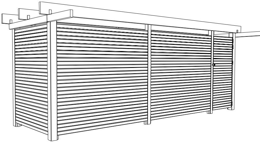
**NL:** Montage van de beringing in QB-profielen. Het is heel belangrijk dat u de afstanden tussen de palen opgegeven in de montage instructie van de carport zelf strikt heeft opgevolgd. Zo niet kan dit problemen geven bij de montage van de planken tussen de palen.
