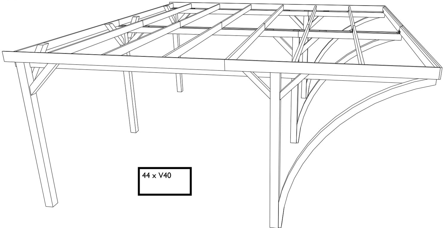
Conformément au dessin ci à côté, fixez les lattes sur les traverses de manière que la toiture soit cachée par les lattes de décoration (voir dessin). Placez les lattes de décoration frontales avant les lattes de décoration latérales. Servez vous des vis V40
