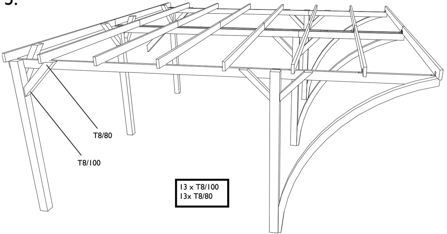
Montez les renforts obliques comme indiqué dans le dessin avec les tirefonds. Vissez à travers les renforts obliques. En bas, vissez à travers le renfort oblique dans le poteau. Avant d'appliquer les tirefonds, toujours pré-percer avec une mèche légèrement plus petite que le diamètre du tirefond.
