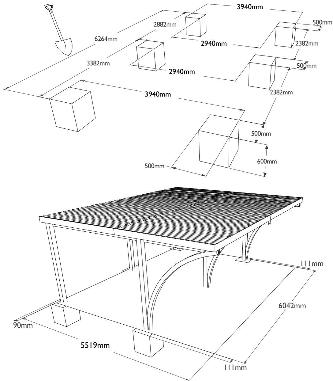
Suivez les mesures du plan ci-joint pour bétonner vos poteaux dans le sol. Prenez bien soin que les poteaux soient bien alignés entre eux et parfaitement verticaux.
