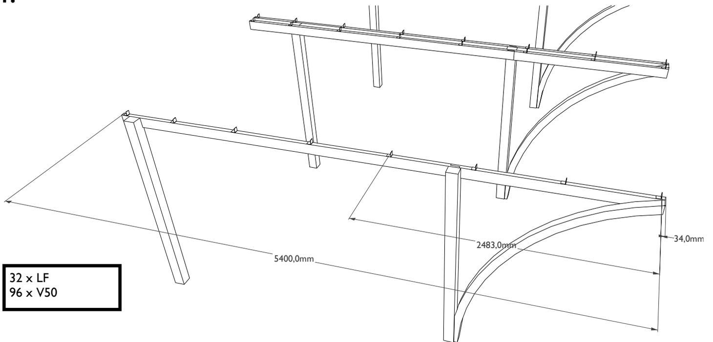
Placez les traverses suivant le dessin. Répartissez le nombre de traverses dans la longueur totale, après avoir monté les traverses avant, au milieu et à l'arrière et ce comme indiqué sur le dessin. Utilisez les équerres en métal et 3 vis V50 par équerre pour les fixer aux poutres. Servez-vous de 3 vis V30 par équerre pour fixer les traverses aux équerres.
