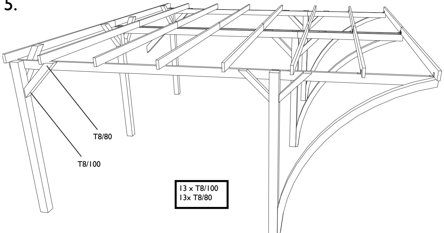
**NL:** Monteer de verstekverstevigingen zoals aangegeven op de figuur met houtdraadbouten. Vijs door de verstekversteving in de dwarsligger of langsligger. Onderaan vijst U door de verstekversteving in de paal. Bij gebruik van houtdraadbouten steeds eerst voorboren met een boor waarvan de diameter licht kleiner is dan de houtdraadbout.
