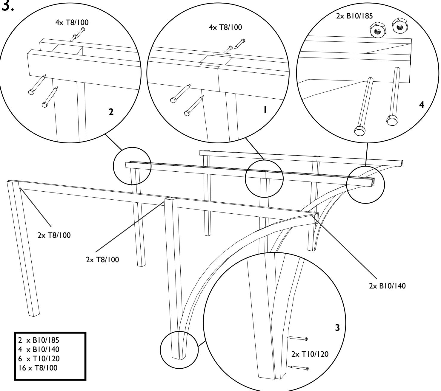
**NL:** De langsliggers komen bovenop de palen in de inkeping. De langsliggers bestaan uit 2 delen die met elkaar verbonden worden bovenop de voorste paal (detail 1). In het midden wordt er een langsligger langs beide zijden van de paal gemonteerd. Gebruik de houtdraadbouten om de beide delen telkens aan de paal vast te maken. Bij gebruik van houtdraadbouten steeds eerst voorboren met een boor waarvan de diameter licht kleiner is dan de houtdraadbout.
