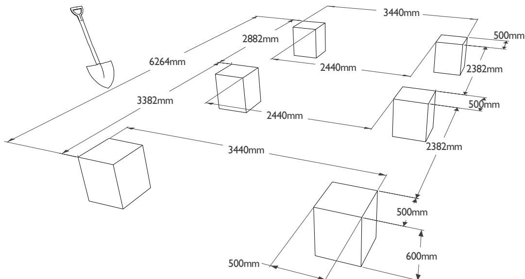
**NL:** Volg de maatindicaties op het bijgevoegd plan om uw palen in de grond te betonneren.. Zorg ervoor dat alle palen onderling mooi uitgelijnd en verticaal staan. Gebruik goede beton, met keien. Laat U adviseren door een deskundige ter zake. Wapen uw beton. Maak putten van 50x50x60 cm. (breedte/lengte/diepte).
