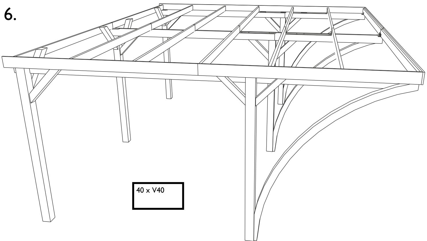
**NL:** Volg de tekening in bijlage. Bevestig de sierlatten op de dwarsliggers zodanig dat de dakbedekking onder de bovenkant van de sierlatten komt te liggen (zie figuur). De frontale sierlatten komen voor de laterale sierlatten. Maak gebruik van de vijzen V40
