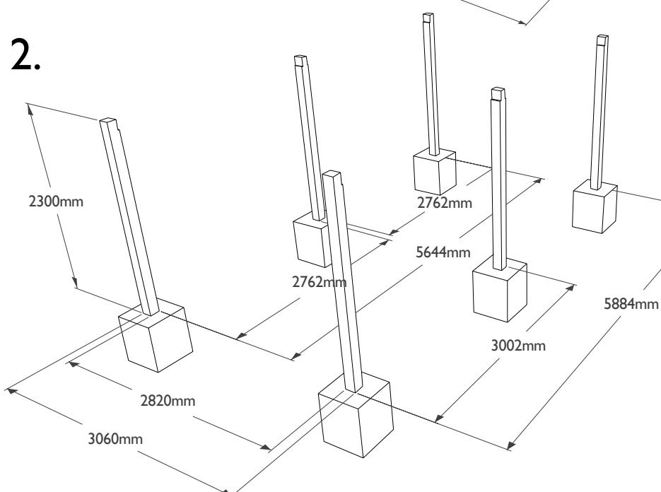
**NL:** Bemerk dat de inkepingen bovenaan de palen naar binnen gericht zijn. Zorg ervoor dat de afwatering kan gebeuren naar de zijde die U wenst (helling 1cm/m is minstens aan te bevelen). Gebruik hulpsukken om de palen op hun plaats te houden bij het storten van het beton. Controleer na het storten of alle palen nog steeds correct opgesteld zijn en pas aan indien nodig. Geef uw beton de tijd om te drogen vooraleer U verder werkt.
