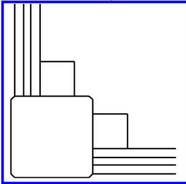
**FR:** Commencez par la paroi à côté de la porte. Utilisez la porte pré-montée pour aligner les planches. Vissez chaque planche de paroi avec 4 vis de 50mm à travers les planches dans les tasseaux.
