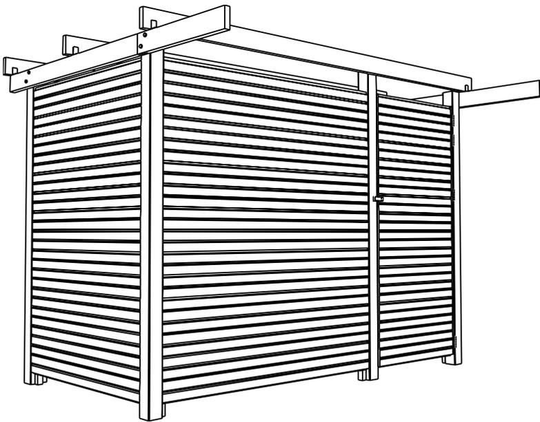
**NL:** Montage van de berging in QB-profielen. Het is heel belangrijk dat u de afstanden tussen de palen opgegeven in de montage instructie van de carport zelf strikt heeft opgevolgd. Zo niet kan dit problemen geven bij de montage van de planken tussen de palen.
