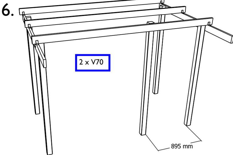
**NL:** Plaats de extra paal naast de deur op de aangegeven maat. Zorg er voor dat de paal mooi loodrecht op de grond staat (gebruik hiervoor opnieuw een waterpas). Bovenaan schroeft u door de dwarsligger de paal vast met 2 vijzen van 70mm. Onderaan dient u zelf te zorgen voor een goeie aansluiting met de ondergrond. Aangezien de deur tegen deze paal zal "slaan" dient dit een stevige verankering te zijn.
