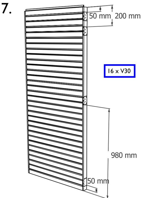
**NL:** Verdeel de scharnieren over de deur. 2 bovenaan, 1 in het midden en 1 onderaan. Gebruik per scharnier 4 schroeven van 30 mm. Zorg dat de knoop van de scharnier net voorbij de deurvleugel uit steekt.
