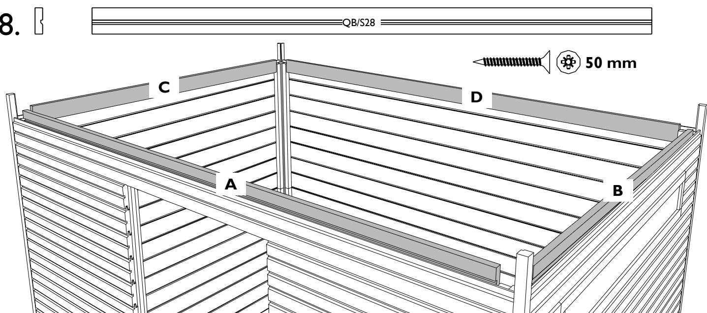
**NL:** De tekeningen tonen een afwatering in de linker hoek. Wissel/spiegel voor een afwatering in de rechter hoek. Mogelijk hebben deze planken geen groef in de lengterichting, dit geeft geen problemen.
