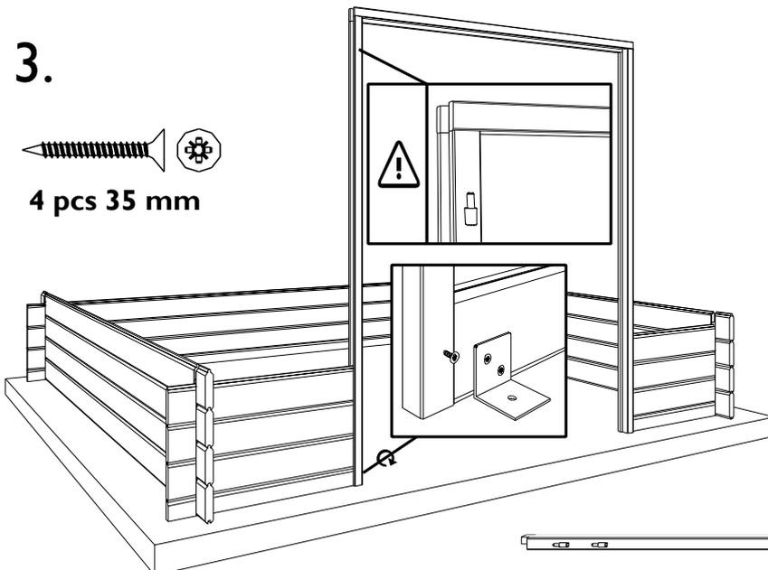
Vissez les parties mâles des charnières dans les montants pré percés. Placez le cadre de la porte dans l'ouverture de la façade (4 pièces). Tenez compte que la porte s'ouvre vers **l'extérieur**. Vissez les montants de la porte aux planches avec des vis de 35mm **UNIQUEMENT** en bas sur la première planche. Vissez la traverse haute aux montants, surtout **PAS** aux planches, utilisez des vis de 35mm. **Attention!** Attendez pour placer la porte jusqu'à ce que votre abri soit complètement monté.
