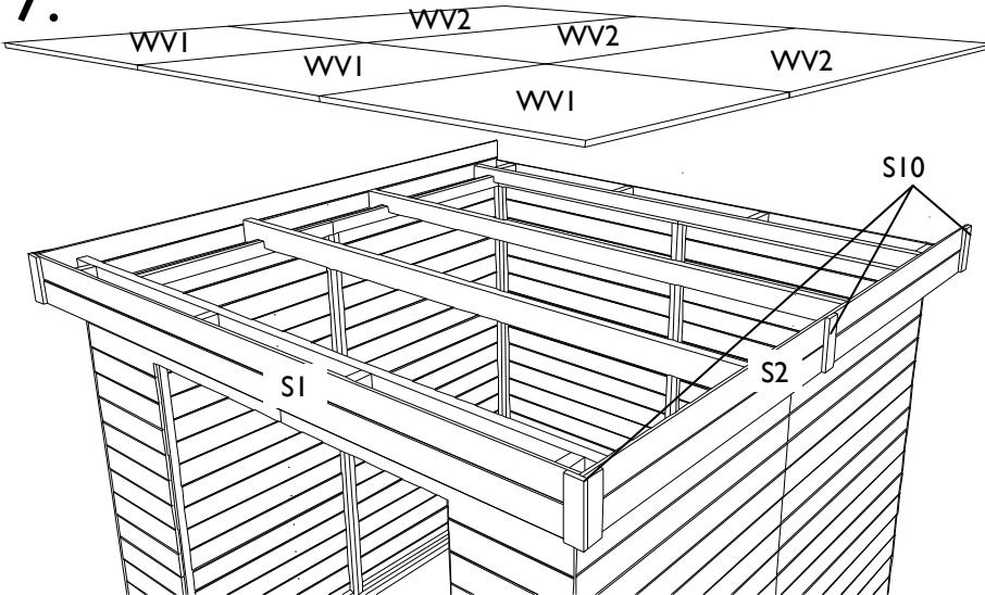
**NL:** De frontale (S1) en zijdelingse sierlatten (S2) bestaan telkens uit een plank met groef en een plank met tand. Vijs ze aan elkaar met behulp van de latjes S10 en vijzen van 25 mm zoals op de tekening. Vijs de sierlatten tegen de dakbalken en hulpdakbalken met vijzen van 30mm. Vijs de dakplaten op het geheel. Gebruik 6 vijzen van 50 mm per paneel.
