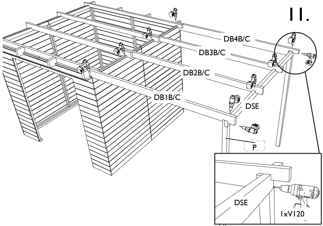
**FR:** Assemblez d'abord le support toit en vissant la poutre DSE sur les deux
