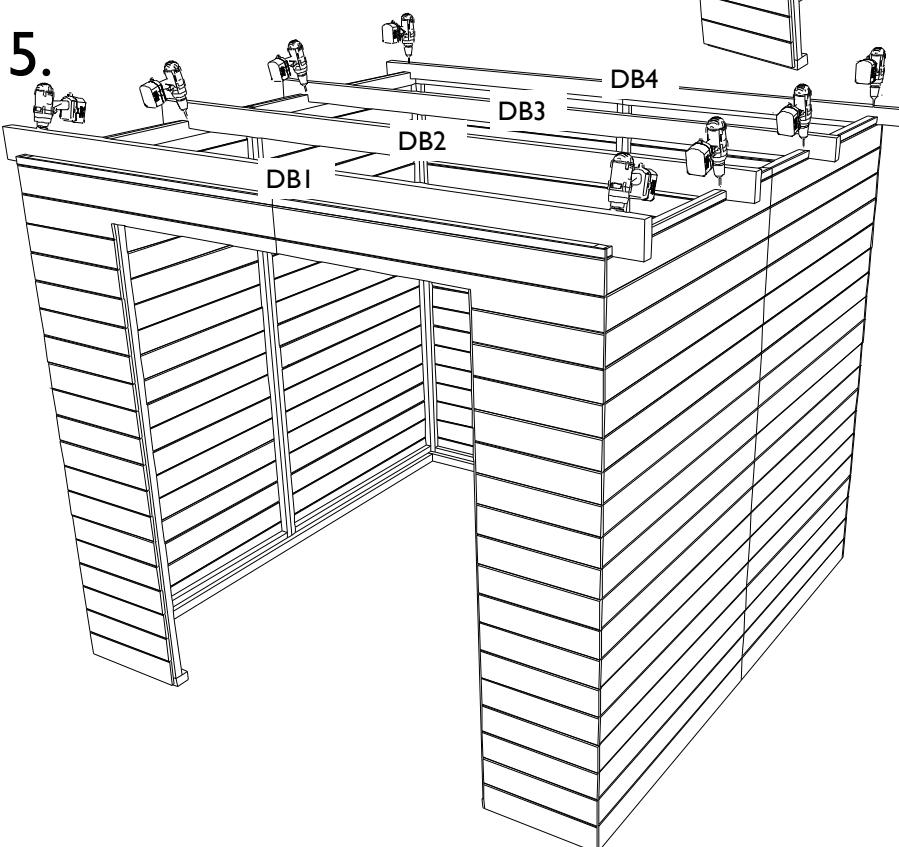
**NL:** Vijs de dakbalken DB1 tem DB4 vast op de zijwanden met 2 vijzen van 70 mm, schuin geplaatst. Plaats de buitenste dakbalken helemaal tegen de voor en achterwand. Tussen DB1 en DB 2 dient U een afstand te hebben van precies 72 cm. DB3 plaatst U precies in het midden tussen DB2 en DB4.
