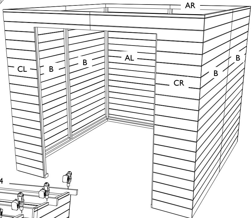
**NL:** werk de wanden verder af door de panelen telkens met 3 vijzen van 50 mm aan elkaar te vijsen en met 2 vijzen van 50mm aan de vloer(balken). Vergeet ook hier niet rekening te houden met de zwelnaad van 5 mm rondom. Hou de panelen tegen zolang u de volgende hoek niet vastgemaakt hebt aan de vloer (balken). Ga na of alles mooi pas gemonteerd is.
