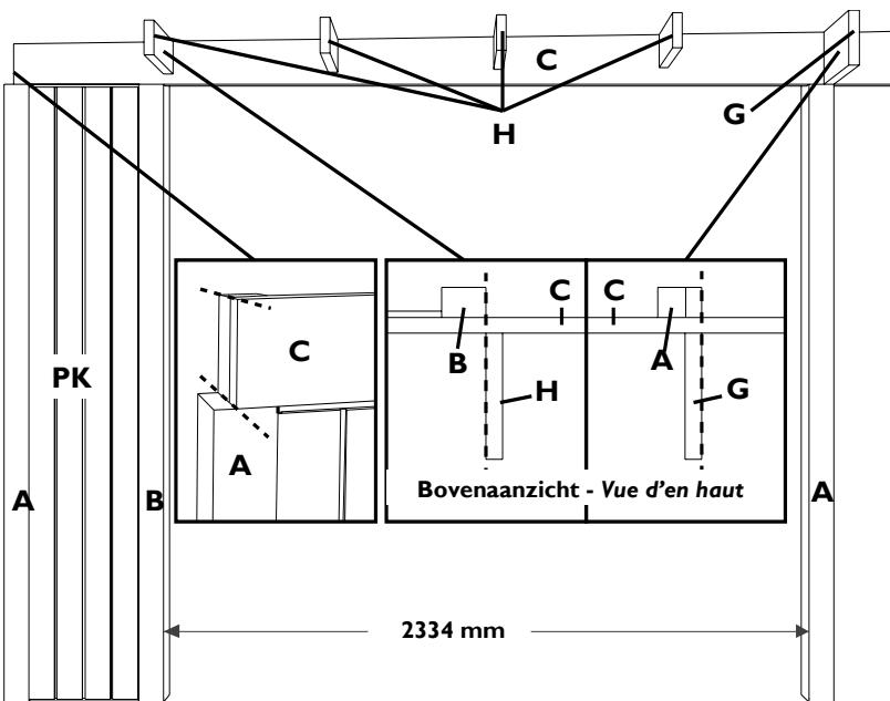
**NL:** Maak de zijwand. U doet dit het makkelijkst op de grond. Schroef het paneel PK tussen de hoekpaal A en de steunpaal B. Montere zodanig dat de buitenzijde van het paneel mooi aansluit met de buitenzijdes van de palen. (gegroeid paneel zit net tussen de palen) Plaats 3 schroeven van 70mm links en rechts door de kader in de palen.
