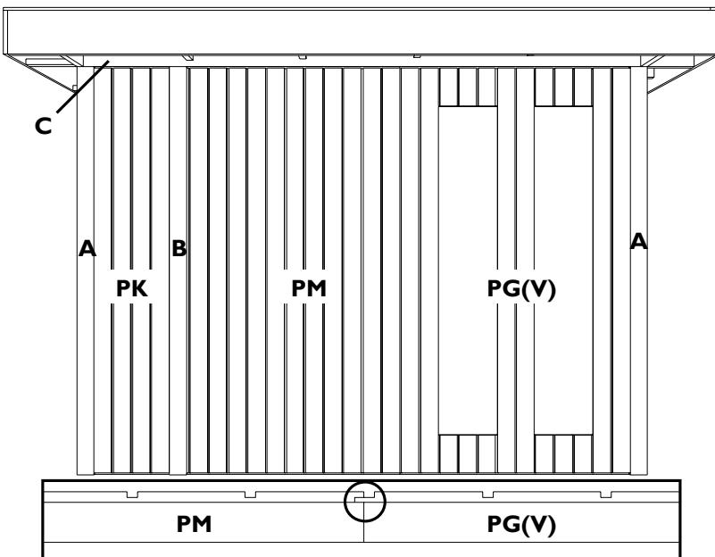
**NL:** De panelen overlappen onzichtbaar dankzij de tand en groef verbinding in de gegroefde bekledingsplaatjes. Vijs de panelen aan elkaar en aan de palen A en B vast met telkens 3 schroeven van 70mm. Maak de panelen bovenaan vast aan de langsligger C met 2 vijzen van 70mm per paneel. Vergeet zeker niet de panelen vast te maken aan de ondergrond (bv L-ijzer, betonplug e.d.; niet meegeleverd).
