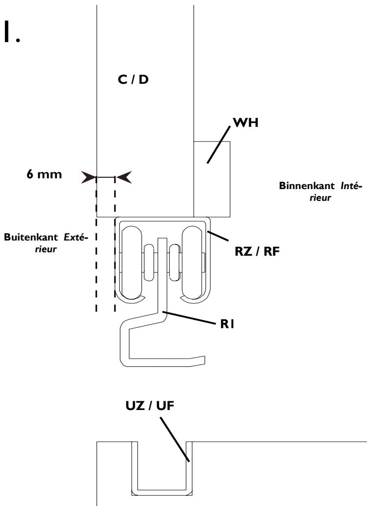
**NL:** Plaats onderaan de grondlat S tussenin de palen Zorg ervoor dat de grondlat S mooi aansluit bij de buitenzijde van de palen. Zorg ervoor dat voorgeschaafde groef aan de buitenzijde komt te liggen. Plaats het U-profiel UZ/UF in de voorgeschaafde groef. Maak het U-profiel vast door de grondlat S aan de ondergrond, gebruik de meegeleverde pluggen en vijzen van 70mm.
