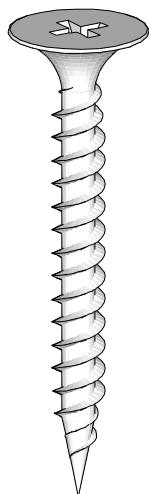
**NL: Vijzen = Voorboren!** Om te vermijden dat hout splijt tijdens het vijzen dient u telkens voor te boren met een boor met een diameter gelijk aan de diameter van de kern van de vijs.
