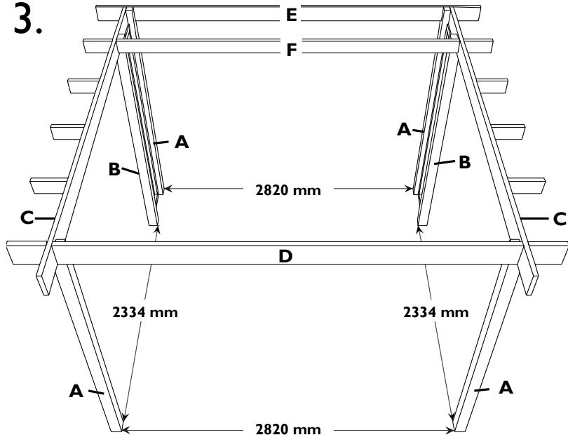
**NL:** Monteer de achterpanelen (2x PG en 1xPK). De panelen overlappen onzichtbaar dankzij de tand en groef verbinding in de gegroefde bekledingsplaatjes. Vijs de panelen aan elkaar en aan de palen A vast met telkens 3 schroeven van 70mm. Maak de panelen bovenaan vast aan de dwarsligger E met 2 vijzen van 70mm per paneel. Vergeet zeker niet de panelen PG en PK van de achterwand één van de zijwand vast te maken aan de ondergrond (bv L-ijzer, betonplug e.d.; niet meegeleverd).
